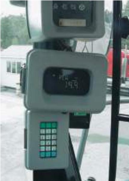
**Sistema de Control de Carga Útil.** Las básculas, diseñadas específicamente para máquinas Cat, permiten el pesaje del material del cucharón sobre la marcha. Los operadores cargan los camiones con mayor precisión y eficiencia. Cargar correctamente los camiones la primera vez equivale a ciclos más rápidos para el operador y a una mayor productividad en su operación.
