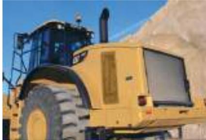
**Capó nuevo.** Se ha diseñado un capó nuevo para el 980H. El nuevo capó, de dos capas de espesor, tiene una mayor durabilidad a la vez que mantiene la visibilidad del terreno. El capó reforzado es más resistente al viento y a la acumulación de barro. También se ha mejorado el sistema de accionamiento. Dispone de cilindros de levantamiento dobles activados electrohidráulicamente que reducen considerablemente el tiempo de subida y bajada.
