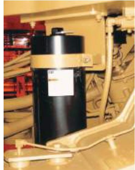
**Control de Amortiguación.** El Sistema de Control de Amortiguación mejora la amortiguación, el rendimiento y la retención de carga al desplazarse por terrenos accidentados. Los operadores toman confianza al desplazarse a mayores velocidades en las operaciones de carga y acarreo disminuyendo los ciclos y aumentando la productividad.
