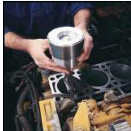
**Piezas remanufacturadas.** Los motores y los componentes principales de Cat están diseñados para ser remanufacturados y proporcionar ciclos de vida útil múltiples. El programa de remanufactura de Cat es más amplio que la mayoría de los programas de reconstrucción. Los componentes son realmente remanufacturados en fábrica según las especificaciones originales con las actualizaciones necesarias de los productos.
