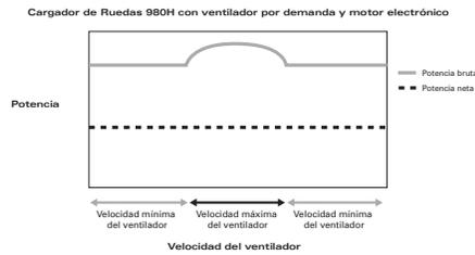
**Potencia neta constante.** El motor compensa automáticamente las cargas parásitas, como el ventilador de un acondicionador de aire, para mantener un nivel uniforme de productividad.
