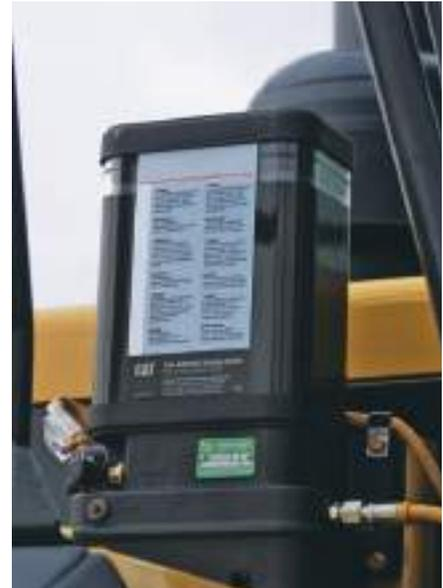
**Lubricación automática.** Disminuya el tiempo empleado en el mantenimiento diario y el tiempo de parada debido a reparaciones no programadas causados por un engrase inadecuado con el Sistema de Lubricación Automática optativo de Caterpillar. La lubricación precisa de los pasadores y bujes a intervalos específicos disminuye el desgaste de los componentes y reduce la contaminación del terreno debida a un engrase excesivo.
