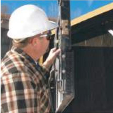
**Enfriamiento.** Los núcleos del Radiador Modular de Nueva Generación (NGMR) constituyen un diseño modular que permite el reemplazo de un solo núcleo sin quitar todo el radiador – reduciendo los costos de reparación y el tiempo de inactividad. Dispone de una mirilla ubicada en el tanque de derivación que permite efectuar comprobaciones rápidas de servicio. La rejilla perforada y corrugada se abate hacia afuera para facilitar el acceso a los núcleos de enfriamiento.
