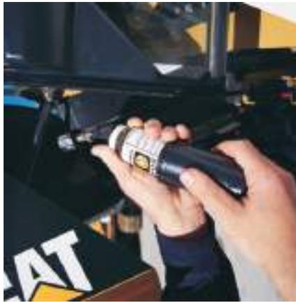
**Muestreo de fluido S•O•S.** Las válvulas de muestreo de aceite permiten un acceso rápido al motor, a la transmisión y a los aceites hidráulicos para el análisis de S•O•S. Los orificios de muestreo para la dirección, la transmisión y los frenos están agrupados en compartimientos de servicio trabables detrás de la cabina. El programa S•O•S permite detectar problemas antes de que ocurran y facilita una programación más conveniente del servicio.
