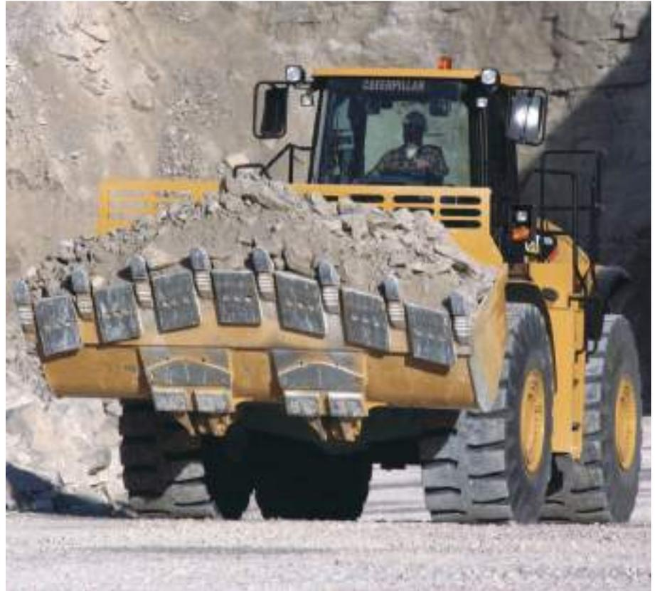
**Cargador Industrial.** Su protector de servicio pesado y sus características especiales están diseñados específicamente para aplicaciones industriales, como el manejo de desechos y de chatarra, lo que permite que el 980H soporte las condiciones más exigentes. Se puede añadir a la máquina herramientas que están diseñadas especialmente para estas aplicaciones.
