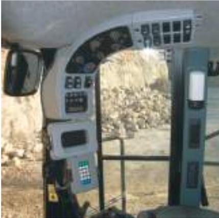
**Sistemas integrados.** El Sistema Monitor Caterpillar (CMS) vigila los sistemas principales de la máquina para alertar al operador sobre la necesidad potencial de servicio. Tres niveles de advertencia permiten al operador evaluar la situación con mayor precisión. El CMS está conectado al motor, transmisión, sistemas hidráulicos y frenos, conectando todos los sistemas principales, lo que permite que el cargador trabaje como un sistema completamente integrado, desde el varillaje hasta el motor.
